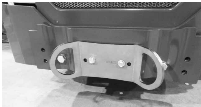
Soporte de amarre A418623 instalado en el parachoques o contrapeso traseros
